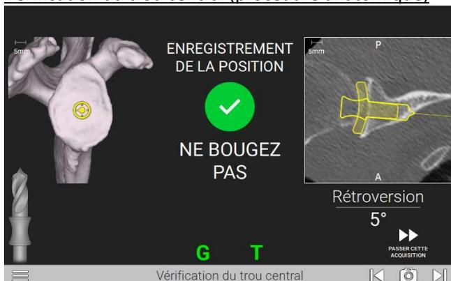
L'utilisateur peut procéder au démarrage de la vérification de deux manières : en gardant l'instrument stable pendant quelques secondes, ou en cliquant sur « suivant » (à l'écran ou à l'aide du palpeur) pour une capture immédiate.
