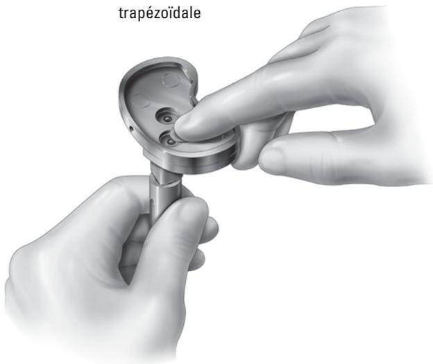
La taille de cale doit correspondre à la taille d'embase tibiale identifiée par un nombre suivi d'un « T » sur la boîte de l'embase (exemple : 3F/2T, la cale de taille appropriée pour cette embase est la taille 2). Il est nécessaire d'enlever les vis des cales tibiales avant de les mettre en place sur la face inférieure de l'embase tibiale trapézoïdale (Illustration 45).
