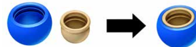
Illustration 16 Utilisation du réducteur d'essai 22,2 mm (en option)
