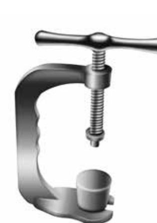
Illustration 18 Assemblage de la presse à insert
